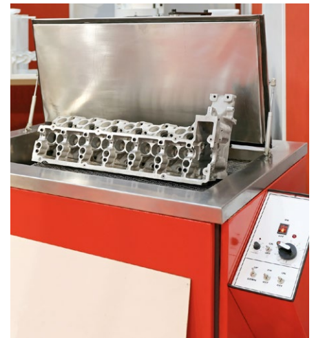
Anlage zur Reinigung von Metallteilen
